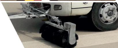
ماشین مجهز به جاروی هیدرولیکی جهت زدودن آلودگی از سطح باند
